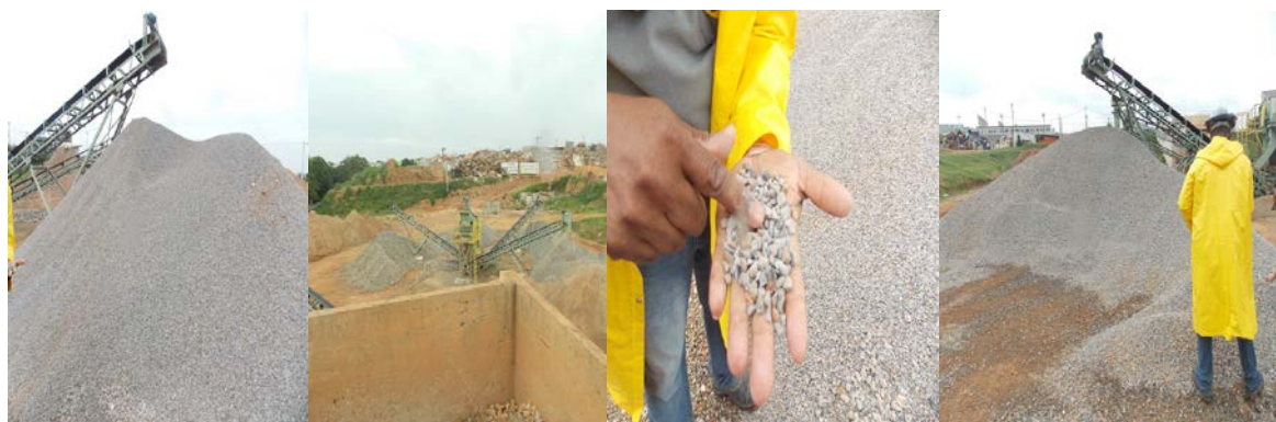
Imagem 7: Material após reciclagem em suas pilhas. Usina de Reciclagem de Entulhos em Hortolândia.
